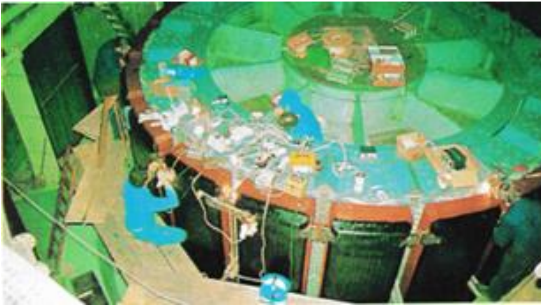
Rotor d'alternateur en cours d'équipement pour la mesure des sollicitations
