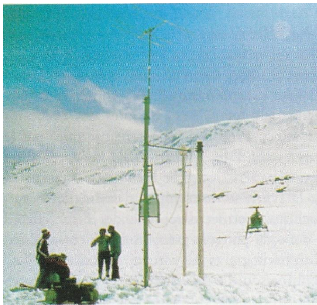
Mesures d'enneigement par télénivomètre
